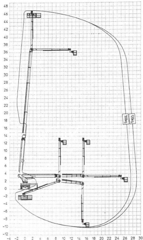
Possibilità di lavorare sottocarpa fino ad un max di 10 mt come da grafico riportato, con ingombro max in carreggiata di 4 mt.
